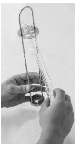
Abb. 4 Einführen bzw. Austauschen eines Viskosimeters mit Lichtschrankenabtastung
